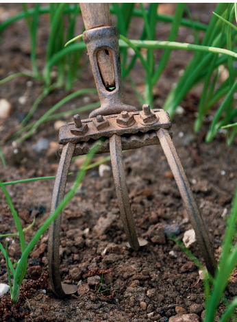
Dank der drei Zinken lässt sich der Grubber besonders leicht durch die Erde ziehen.
