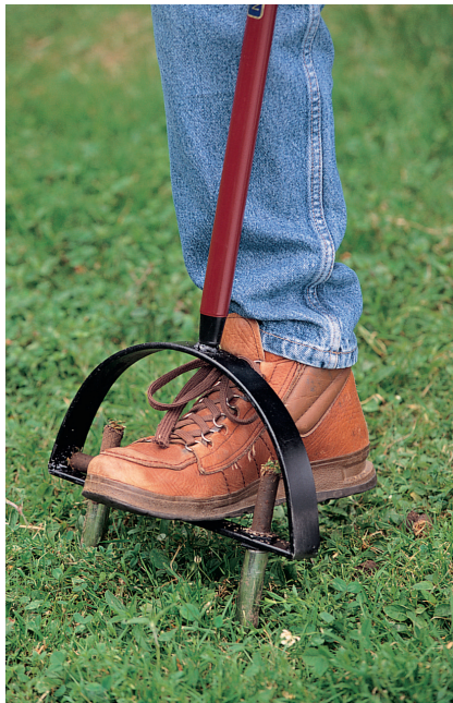
Mit einer Aerifiziergabel können Sie nach dem ersten Mähen verdichtetem Rasen zu mehr Luft verhelfen.
